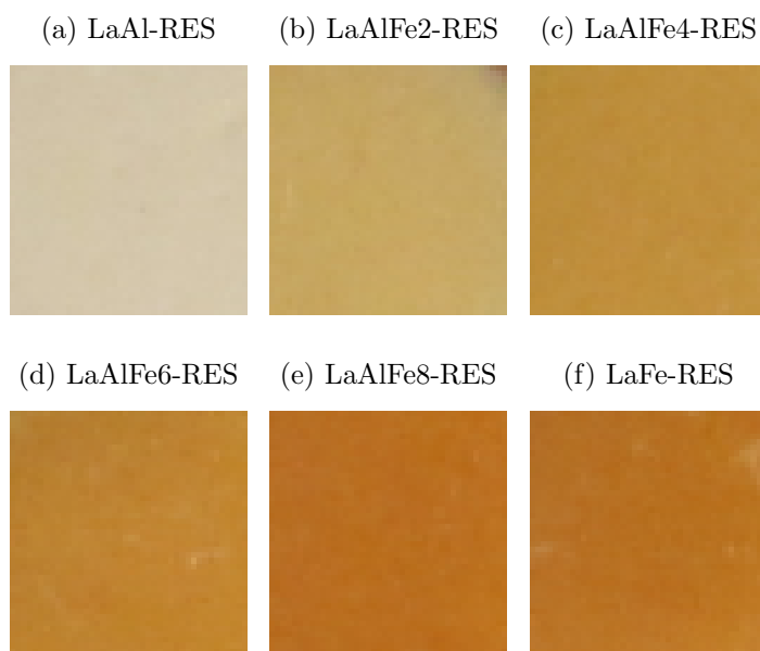
Figura 56 – Fotografias mostrando as cores dos esmaltes de FBT com os pigmentos \text{LaAl}_{1-x}\text{Fe}_x\text{O}_3 sintetizados por RES
