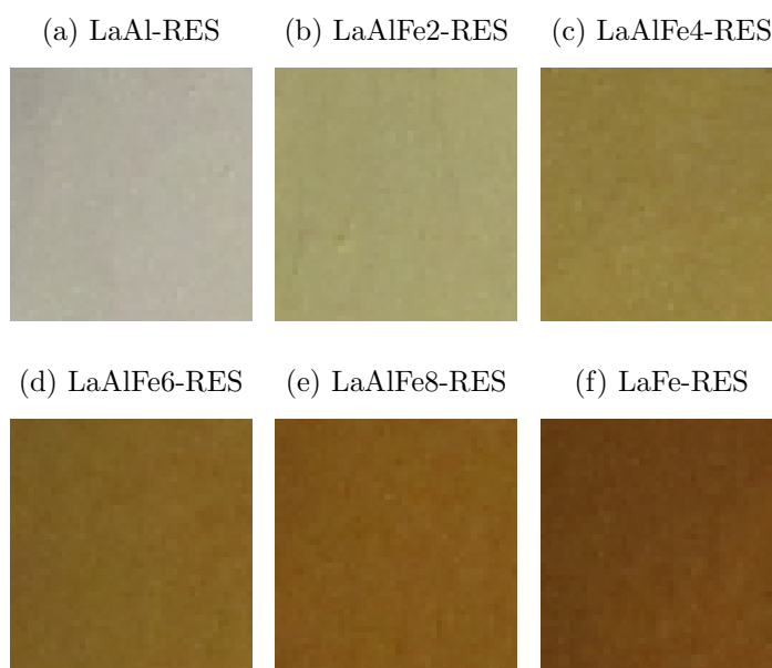
Figura 52 – Fotografias mostrando as cores dos pigmentos \text{LaAl}_{1-x}\text{Fe}_x\text{O}_3 sintetizados por RES
