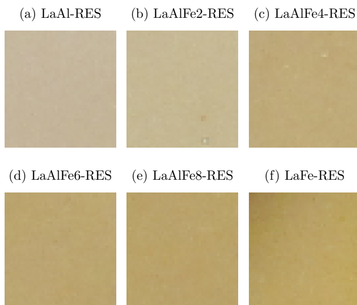
Figura 58 – Fotografias mostrando as cores dos esmaltes de FT com os pigmentos \text{LaAl}_{1-x}\text{Fe}_x\text{O}_3 sintetizados por RES
