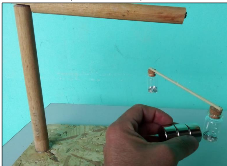
Figura 20 - Papel alumínio que está dentro do frasco de vidro é atraído pelo campo magnético do ímã de neodímio que está na mão do experimentador.
