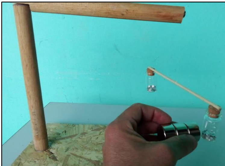
Figura 18 – Papel alumínio que está dentro do frasco de vidro é atraído pelo campo magnético do ímã de neodímio que está na mão do experimentador.
