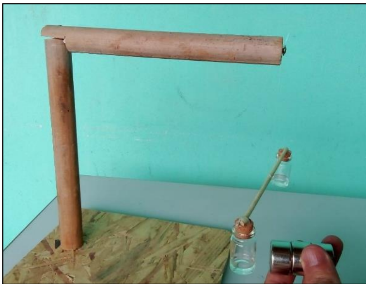
Figura 19 - Água que está dentro do frasco de vidro é repelida pelo campo magnético do ímã de neodímio que está na mão do experimentador.
