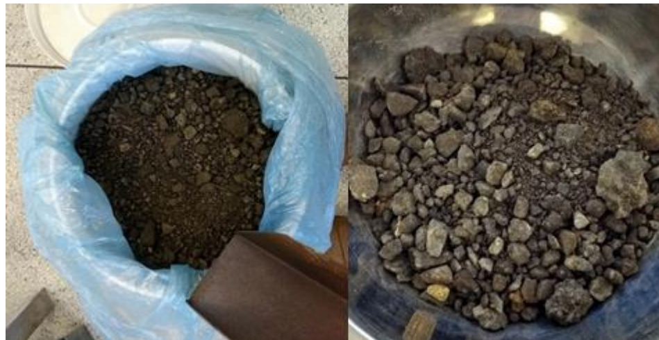
Figura 3 - Fresado de Asfalto (FA)
