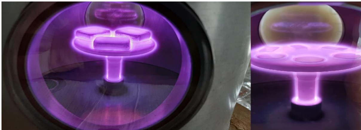
Figura 2 - Plasma gerado durante o processo de nitretação via GD a 600°C, nitretação com atmosfera 50% N 2 + 50% H 2 em volume.
