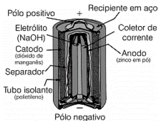
Figura 7. Pilha zinco/dióxido de manganês (alcalina).
