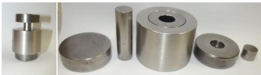
Figura 9. Pastilhador de aço utilizado no processo de prensagem dos corpos poliméricos.
