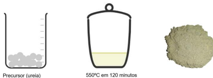
Figura 11 - Esquema de síntese da obtenção do nitreto de carbono grafítico obtido pelo método da policondensação térmica
