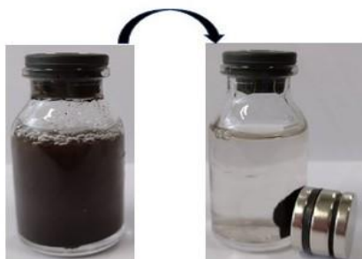
Figura 10 - Espinélio de níquel com propriedades magnéticas verificadas através de um ímã de neodímio
