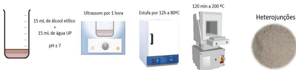
Figura 12 - Esquema de síntese da obtenção das heterojunções de \text{NiFe}_2\text{O}_4 e g-CN x
