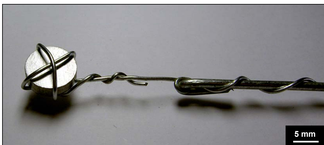
Figura 3.4 Amostra presa ao suporte para a realização do tratamento térmico.
