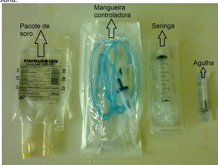
Figura 4.6 – Materiais para se montar um sistema de soro fisiológico utilizado no experimento da adsorção em coluna.
