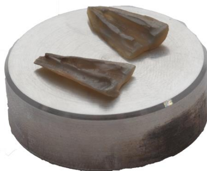
Figura 6- Hemi-seções metalizadas e fixadas em uma matriz metálica para análise em MEV.
