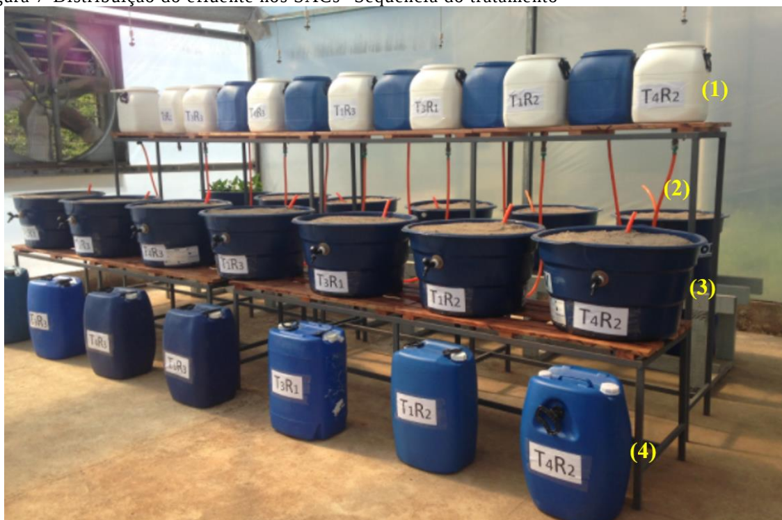
Figura 7-Distribuição do efluente nos SACs- Sequência do tratamento
