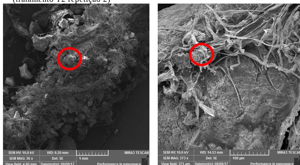
Figura 40-Imagem de microscopia eletrônica da raiz do capim-elefante que foi cultivada no SAC T2R2 (tratamento T2 repetição 2)
