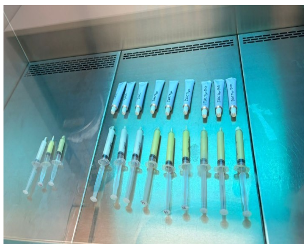
Figura 7 – Amostras dos cremes adesivos DACNys e DACNys:βCD e DAC, acondicionadas em recipientes transparentes, utilizados para exposição à radiação UV-C (254 nm), e em recipientes opacos, destinados à proteção da luz (controle). Ambas as condições foram mantidas sob os mesmos parâmetros experimentais (tempo e temperatura)
