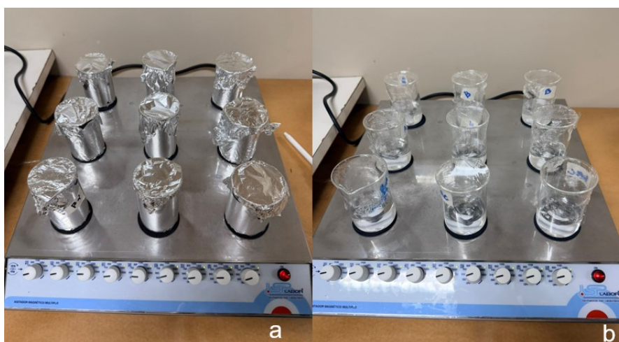
Figura 8 – Extração do fármaco a partir dos cremes adesivos, no qual aproximadamente 0,5 g da amostra foi transferido para um béquer contendo 30 mL de metanol, seguido de agitação magnética e posteriormente de sonicação: a) Formulações protegidas da luz foram envoltas em papel alumínio durante o preparo, a fim de evitar exposição luminosa; b) Grupo de formulações expostas a luz
