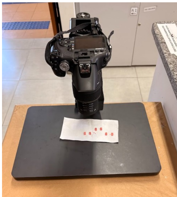
Figura 26 – Câmera posicionada em suporte fixo, mantendo o eixo óptico perpendicular (90°) à superfície dos espécimes e distância focal padronizada
