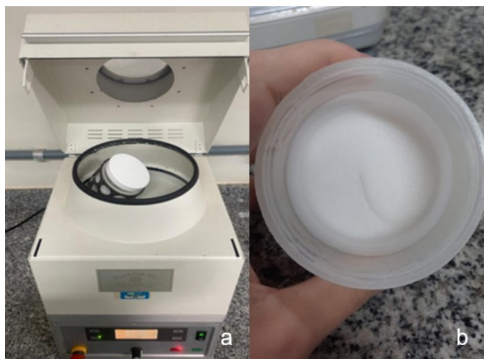
Figura 1 – a) Homogeneização das fases oleosa e aquosa no equipamento SpeedMixer; b) Resultado do creme adesivo após emulsionado
