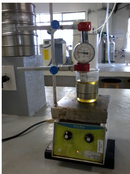
Figura 14- Equipamentos utilizados na reação de transesterificação com óleo de soja e zeólitas.
