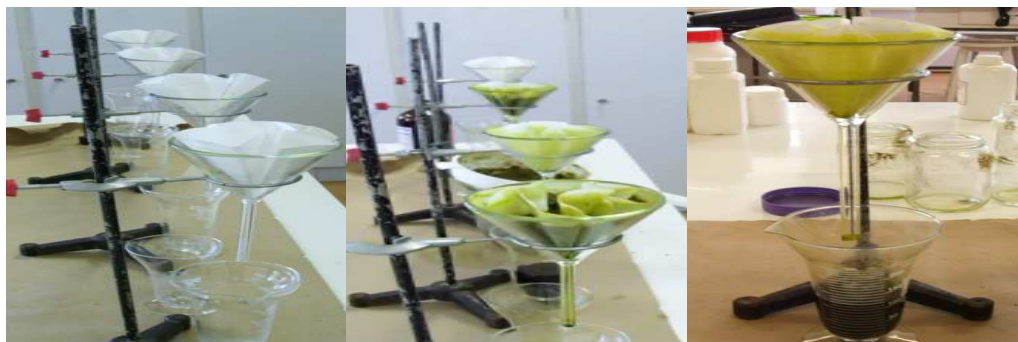
Figura 08 – Processo de filtragem do extrato da planta B. dracunculifolia .
