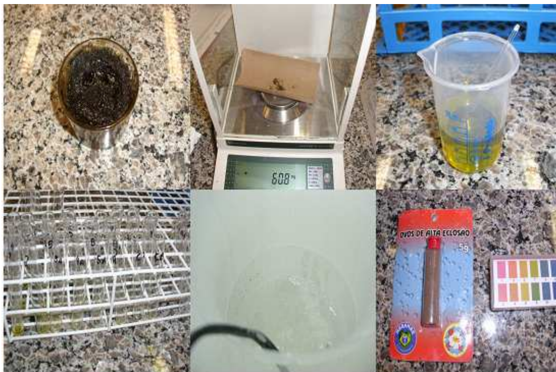
Figura 11 – Teste de toxicidade com Artemia salina . 1 – extrato de B. dracunculifolia ; 2 – pesagem extrato; 3 – solução de extrato e metanol; 4 – tubos de ensaios com as concentrações testadas; 5 – ovos de Artemia salina em processo de eclosão; 6 – ovos do microcústáceo Artemia Salina .
