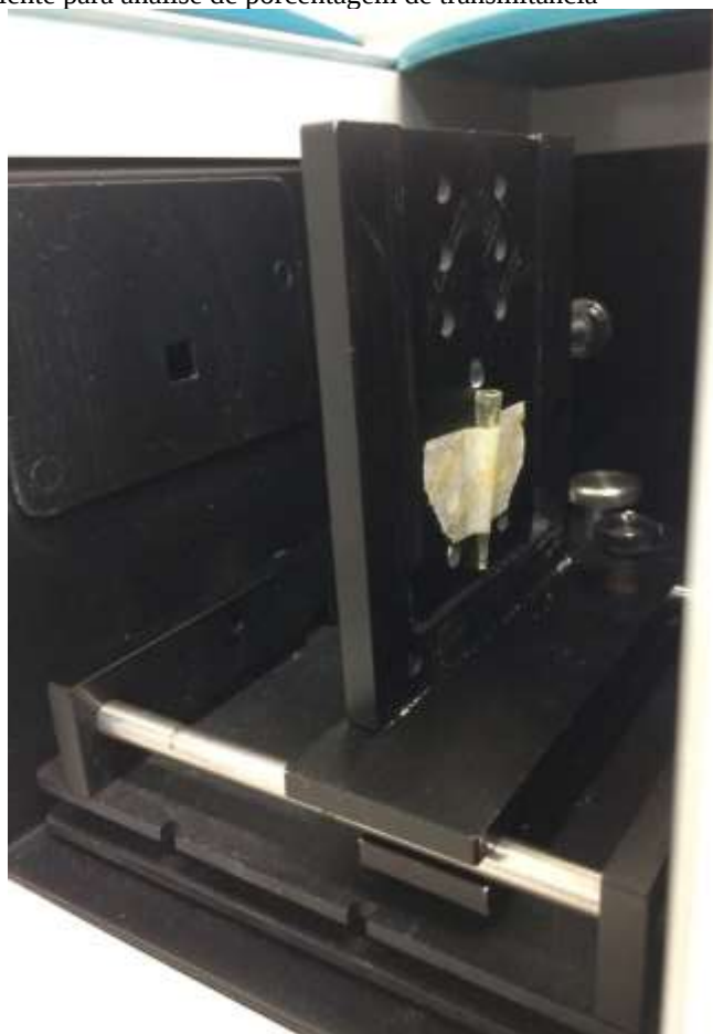
Figura 11 - Suporte de lente para análise de porcentagem de transmitância
