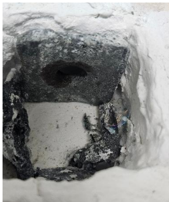
Figura 19 - Caixa refratária e suscepter (SiC) utilizados na sinterização por micro-ondas.
