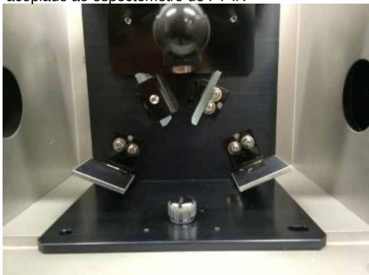
Figura 9: Acessório de reflectância total atenuada acoplado ao espectômetro de FT-iR
