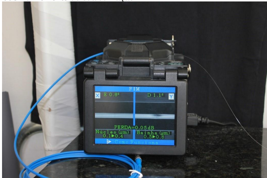
Figura 10: Equipamento de emenda ARC Fusion SPLICER FSM-50S no momento de sua utilização.
