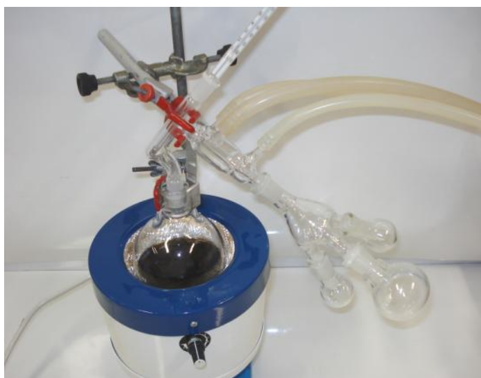
FIGURA 10 – Sistema de destilação de biocombustível à pressão reduzida.
