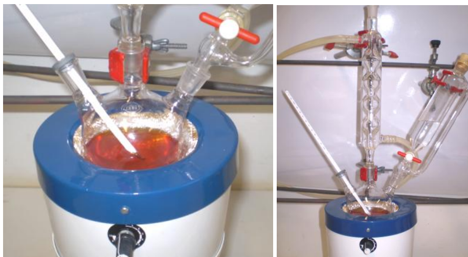
FIGURA 9 – Síntese do biocombustível em balão de três bocas.
