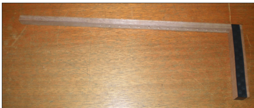
Figura 3.6: Imagem do gabarito de medida do perfil de empenamento das peças rotomoldadas.
