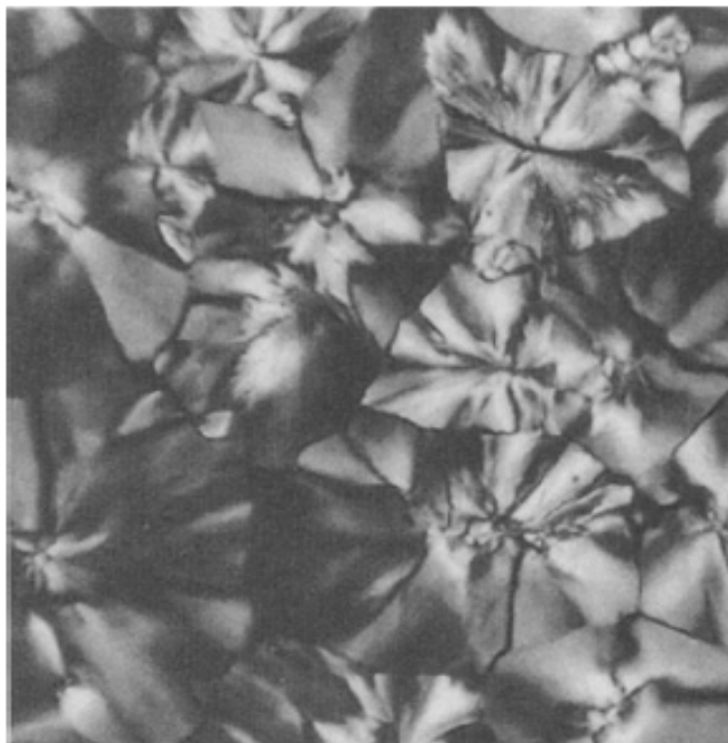
Figura 2.7: Imagem da microestrutura de um polímero semicristalino obtida por microscopia óptica de luz polarizada [25].
