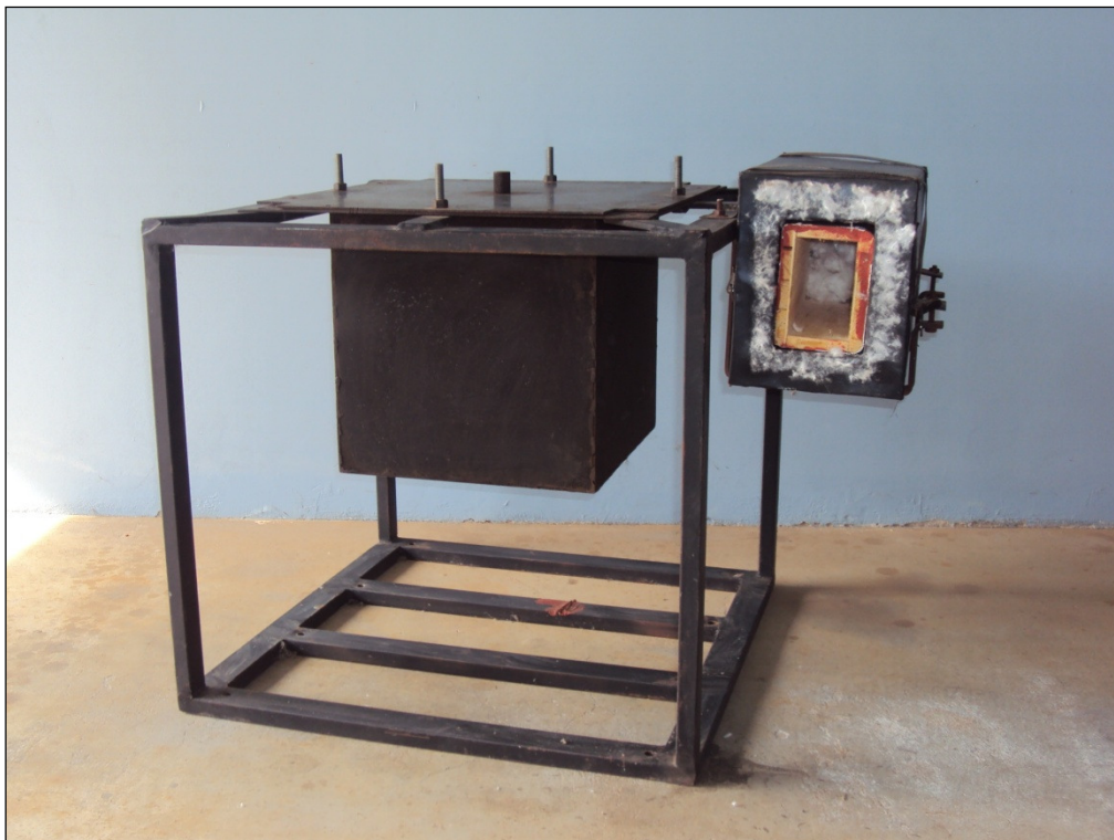
Figura 3.4: Caixa para isolamento térmico do medidor de temperatura.
