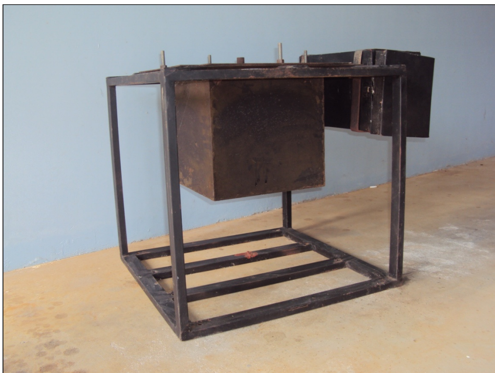
Figura 3.2: Imagem do molde confeccionado para experimentos de rotomoldagem.
