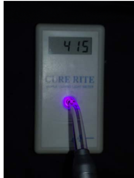
Figura 10- Aparelho à base de LEDs sendo aferido no radiômetro Cure Rite (EFOS)
