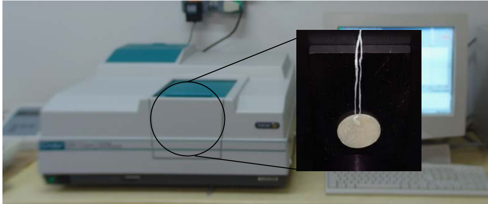
Figura 13- Posição do corpo-de-prova no espectrofotômetro
