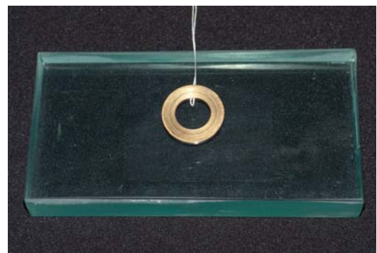
Figura 5 - Placa de vidro com a matriz e o fio dental interposto
