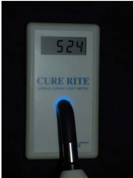
Figura 9- Aparelho de lâmpada halógena sendo aferido no radiômetro Cure Rite (EFOS)
