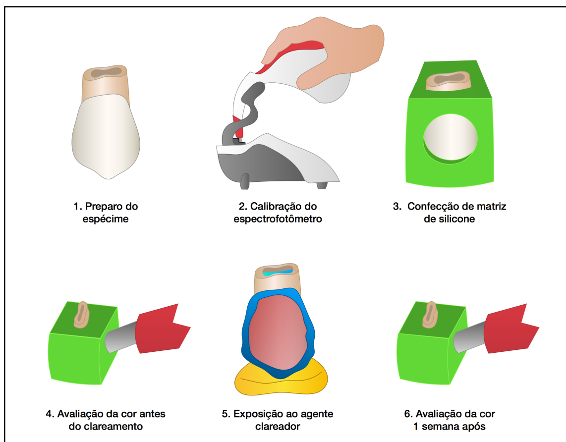
Figura 6. Desenho esquemático dos procedimentos para a avaliação da eficácia do clareamento dental por meio de espectrofotômetro digital.
