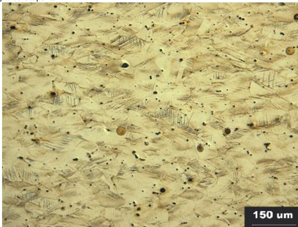
Figura 33 – Microestrutura do aço AISI 316 laminado com 31% de redução na espessura. Reagente metalográfico Carpenter
