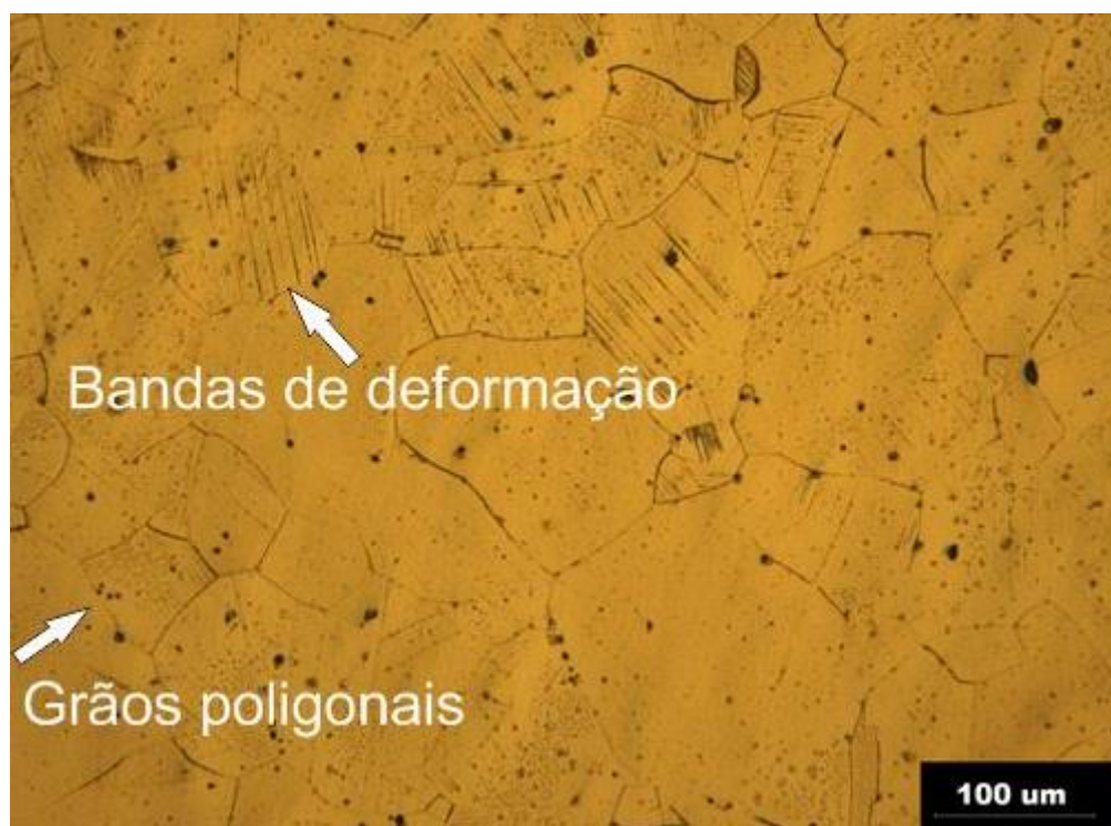
Figura 24 – Microestrutura do aço AISI 316 na direção transversal. Reagente metalográfico FRY
