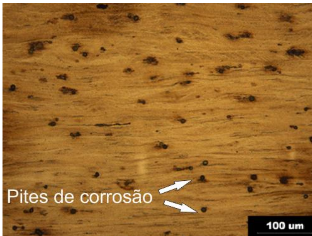
Figura 41 – Microestrutura do aço AISI 304 laminado com 80% de redução na espessura mostrando pites de corrosão devido ao ataque químico. Reagente metalográfico Carpenter
