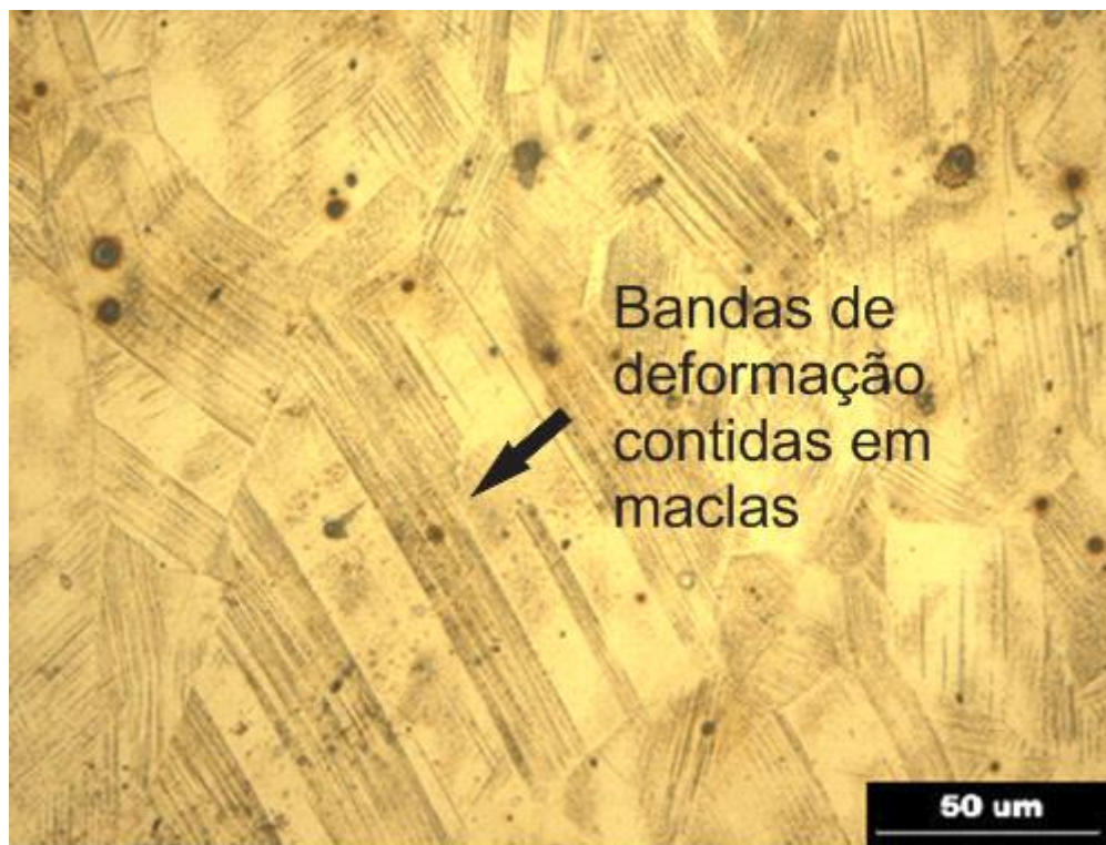
Figura 29 – Microestrutura do aço AISI 304 laminado com 12% de redução na espessura mostrando bandas de deformação e maclas. Reagente metalográfico Carpenter.
