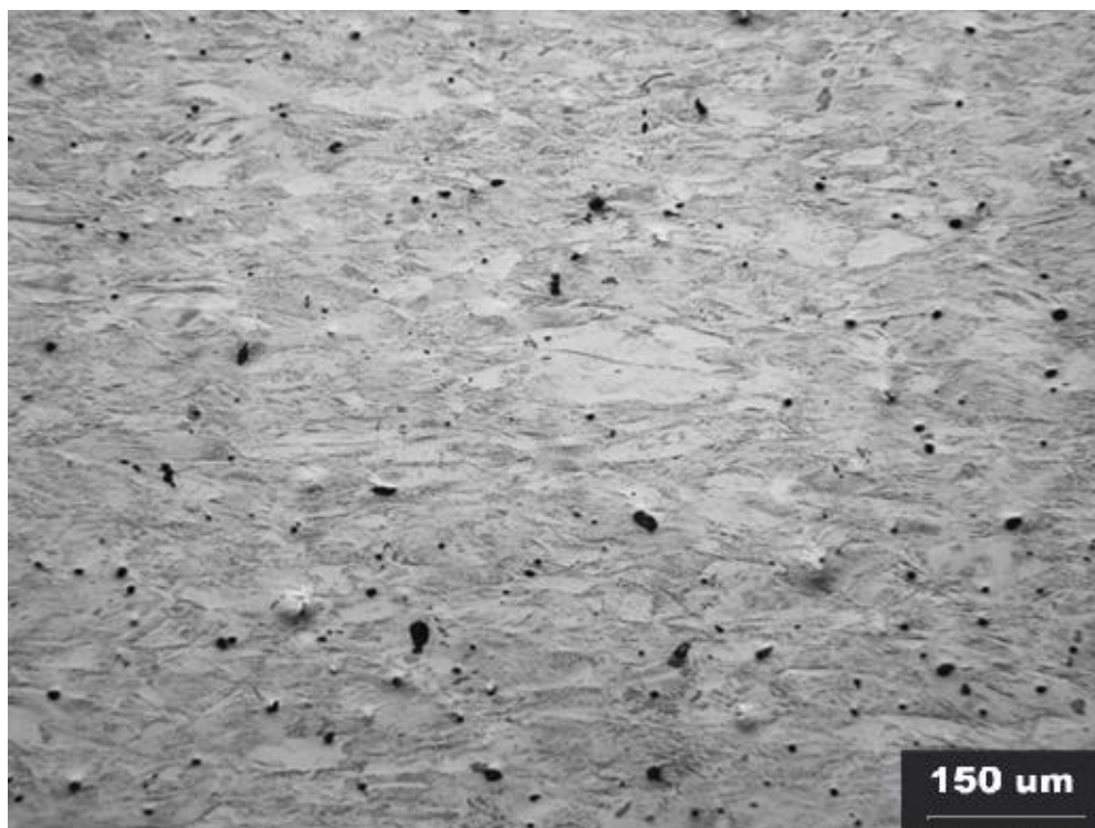
Figura 50 – Microestrutura da seção longitudinal à compressão do aço AISI 304. Reagente metalográfico Carpenter
