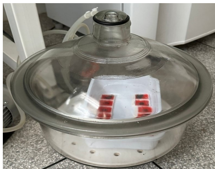
Figura 22. Implantes dentro do dessecador à vácuo
