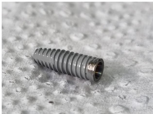
Figura 10. Implante após o tratamento de superfície finalizado
