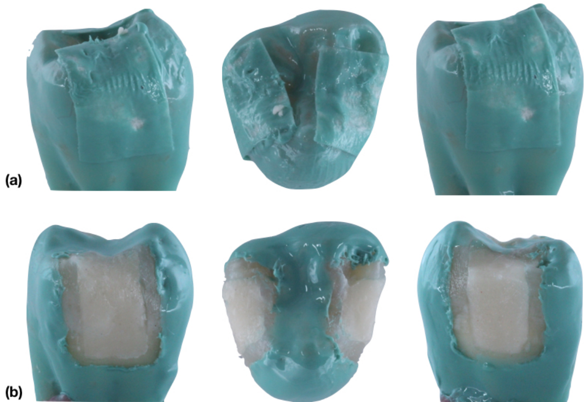
Figura 13. Isolamento dos corpos de prova para Microinfiltração marginal. (a) proteção da restauração com fita adesiva; (b) esmalte colocado no dente, menos a restauração e 1 mm ao redor dela.
