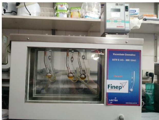
Figura 3 - Viscosímetros capilares do tipo Cannon-Fenske inseridos em banho térmico para análise da viscosidade
