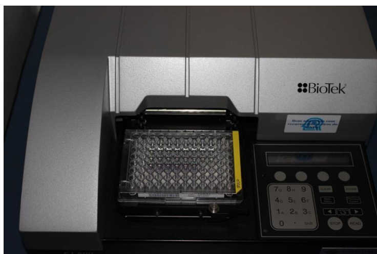
Figura 11- Espectrofotômetro – leitor de placas ELISA - utilizado para leitura da intensidade da luz azul das células viáveis (atividade mitocondrial).
