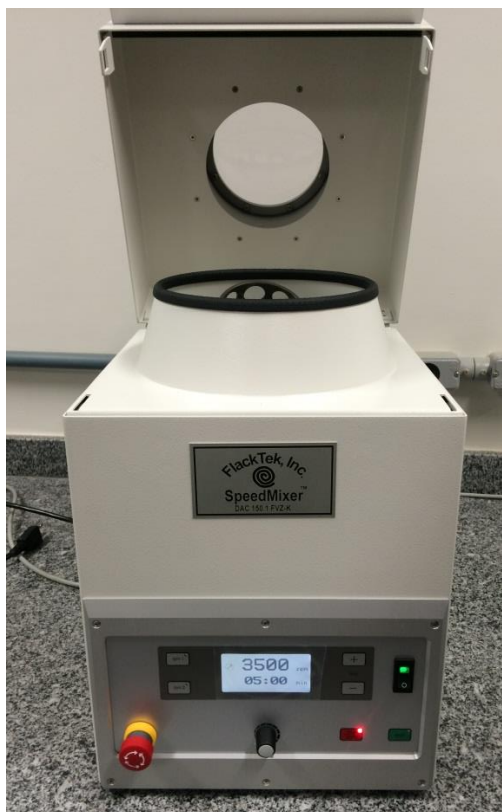
Figura 2 – Homogeneizadora de alta potência para mistura dos compósitos.
