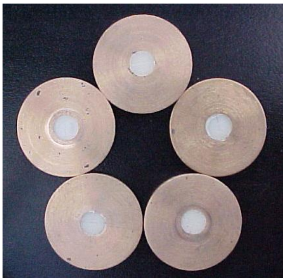
Figura 3 – Matrizes metálicas preenchidas por resina composta.
