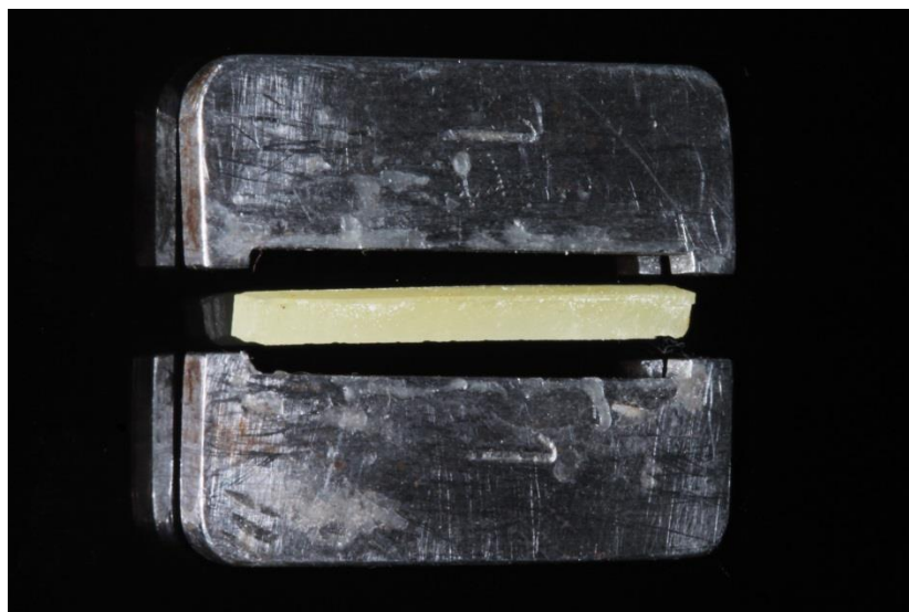
Figura 5- Matriz metálica bipartida (25 X 2 X 2 mm) utilizada para confecção dos espécimes destinados ao teste de resistência flexural.
