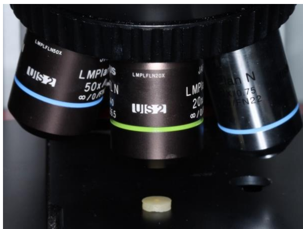
Figura 6- Corpo-de-prova disposto sobre o stage de posicionamento do micro-Raman, na objetiva de 20X.
