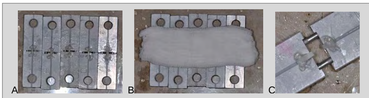
Figura 7 – Série de espécimes preparados para teste de microtração. A – Aspecto dos espécimes em sequência; B – Proteção dos palitos com gaze úmida até serem submetidos ao teste; C – Aspecto do palito fraturado
