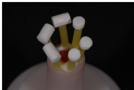
Figura 7 – Padrões de cera dos corpos de prova dos ensaios mecânicos
