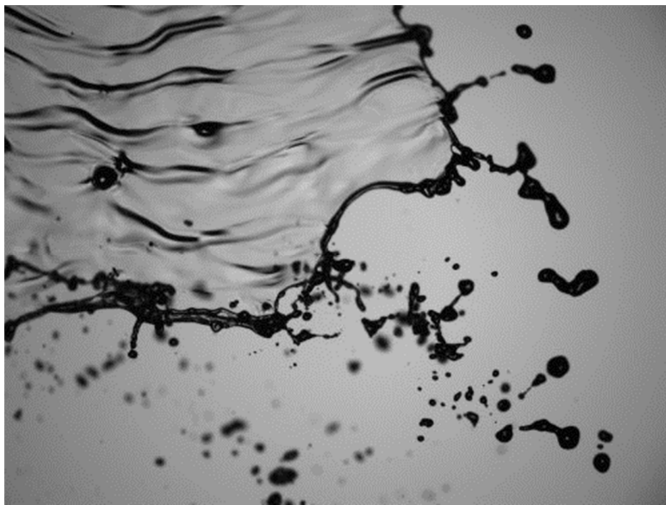
Figura 1 - Formação de gotas através de ponta de pulverização
