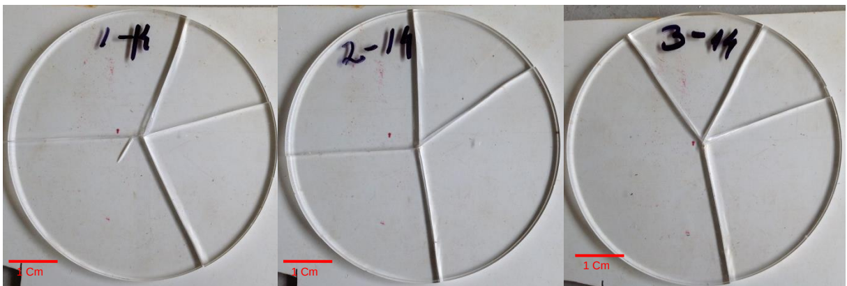
Figura 7. 4: Aspecto de um disco de acrílico fragmentado com ponta cônica acrílico.
