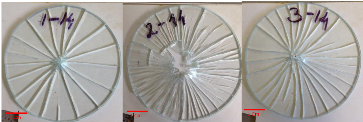
Figura 7. 3: Aspecto de um disco de vidro fragmentado com ponta cônica vidro.
