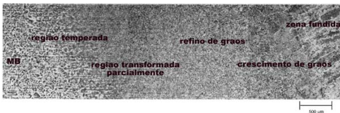
Figure 2.6 Aço A36, soldagem por eletrodos revestidos, múltiplos passes. Composição micrográfica da Zona Termicamente Afetada (ZTA) mostrando (da esquerda para a direita) metal base, região temperada, região transformada parcialmente, região de refino de grão, região de crescimento de grãos, linha de fusão e zona de fusão. Ataque nital 2% [17].
