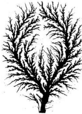
Figura - A3. 4. Fractal estatisticamente auto-similar mostrando conhecido como figura de Lichtenberg foi produzido por uma desaceleração de uma carga elétrica (descarga elétrica corona) que foi injetada dentro de um plexiglas.
