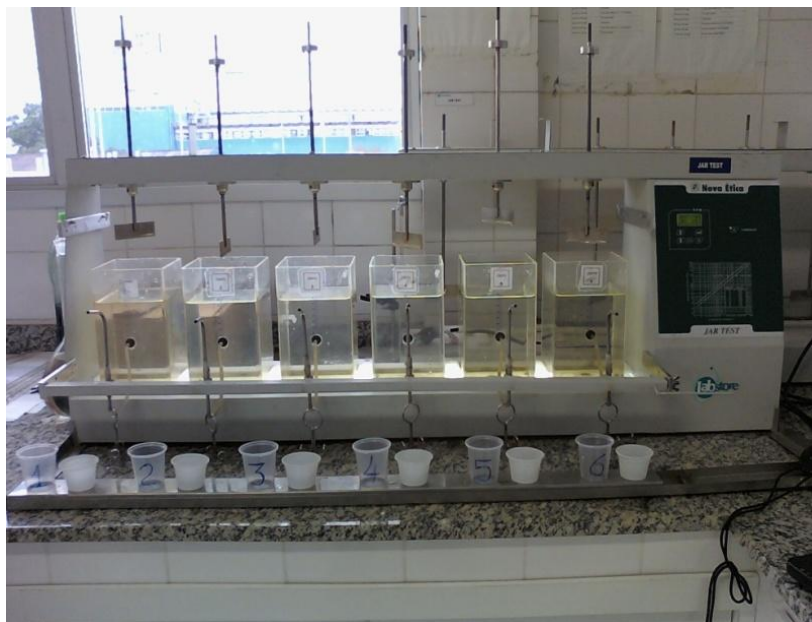
Figura 1 – Jar test do Laboratório de Análises Físico Químicas da Unidade Regional de Ponta Grossa da SANEPAR. Fonte: Selhorst Filho (2010).
