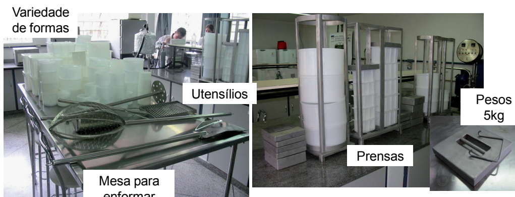
C – Mesa de enformagem, prensas, formas e utensílios para afabricação de queijos
