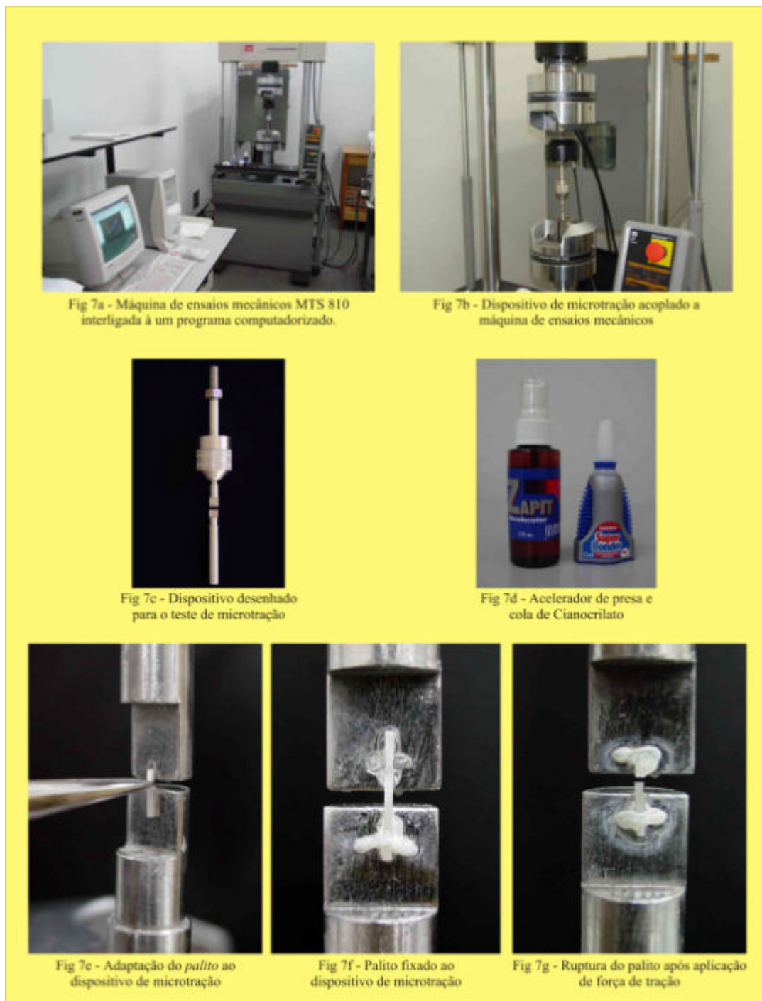
FIGURA 7 – Figuras ilustrativas da seqüência do ensaio mecânico de microtração.
